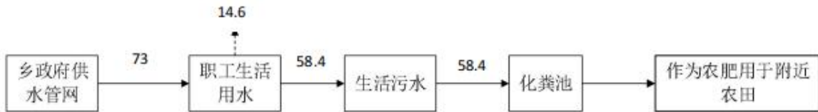
图 4-1 种养水平衡图单位:万 m^3/a
