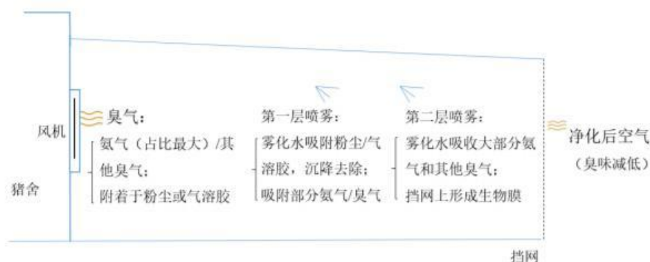
图 4-1 猪舍除臭装置示意图
